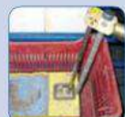
Φορητή συσκευή μέτρησης πυκνότητας και υγρασίας εδάφους με πηγές Am-241 και Cs-137
